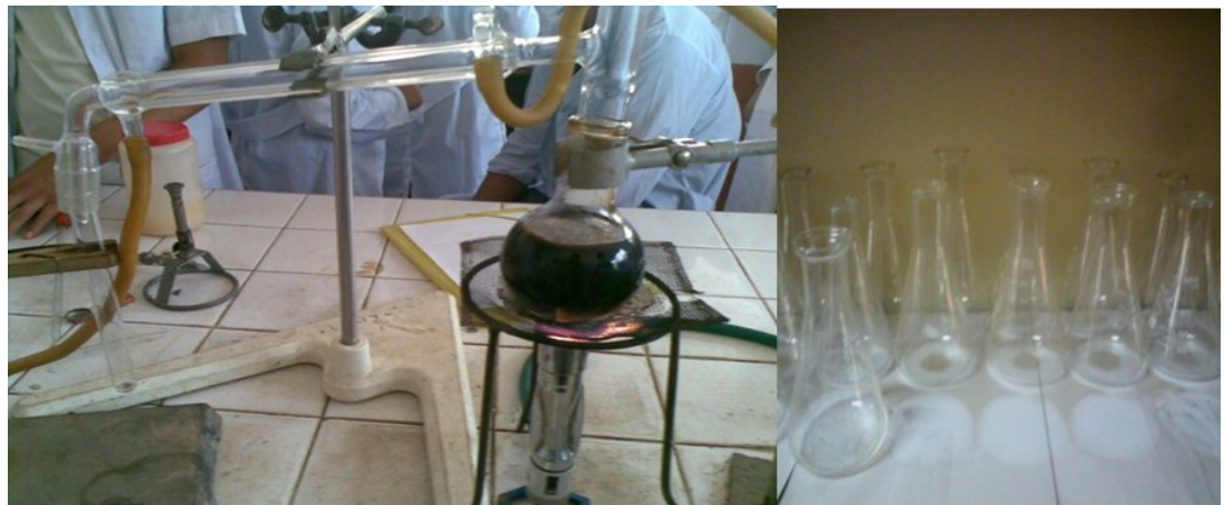
Fotografías 1 y 2. Práctica de laboratorio de destilación sencilla y materiales de vidrio.
